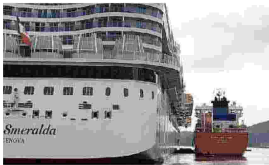
Il rifornimento di gas sulla "Costa Smeralda", alla Spezia
